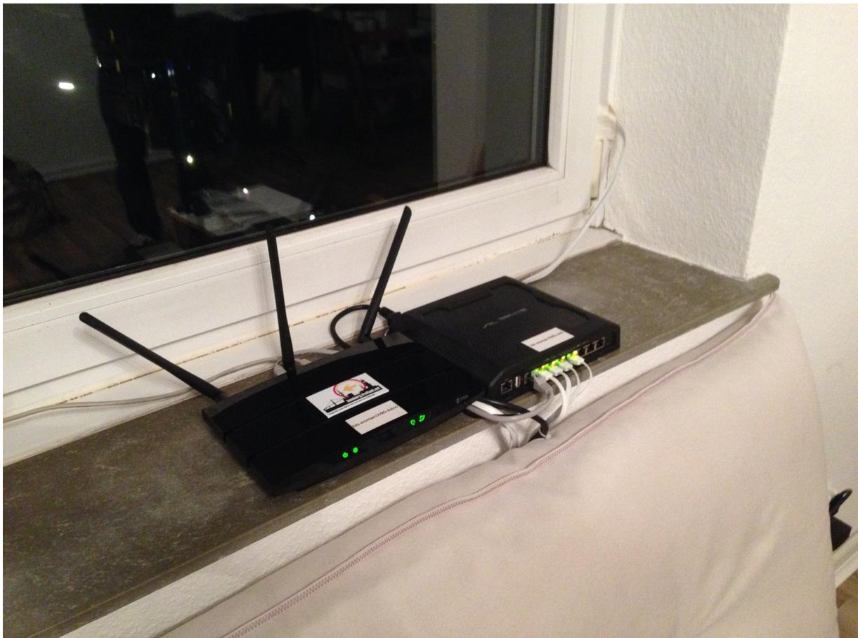
Abbildung 1: Kernrouter und Switch. Non-invasiv: Flachbandkabel durch geschlossenen Fensterrahmen.
